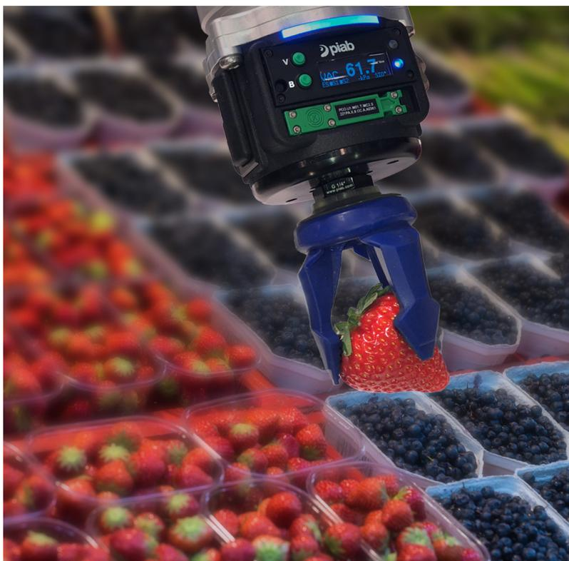
Não é nenhum problema para a ferramenta de pega macia piSOFTGRIP® 50-3, da Piab, que tem três dedos de garra em formato triangular, permitindo-lhe segurar objetos de até 50 mm [1,97 pol] de largura. Ela segurará objetos delicados e leves de geometrias singulares, formatos oblongos e/ou superfície incomum.
