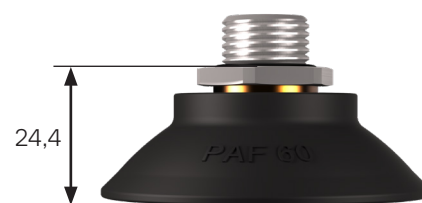
S.PAF 60NP60.G38M.01 Modello ventosa PAF da 60 mm con attacco maschio G3/8" e filtro a rete.
