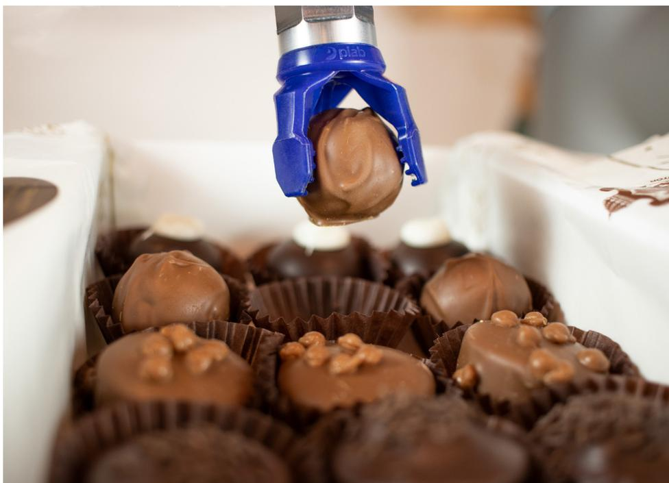
Захват Piab piSOFTGRIP® 30-3 оснащен тремя зажимными пальцами овальной формы с глубокими канавками и вакуумной плоскостью. Данный захват удерживает объекты шириной до 30 мм. Изначально он был разработан для кондитерской промышленности, в частности для автоматической транспортировки конфет.
